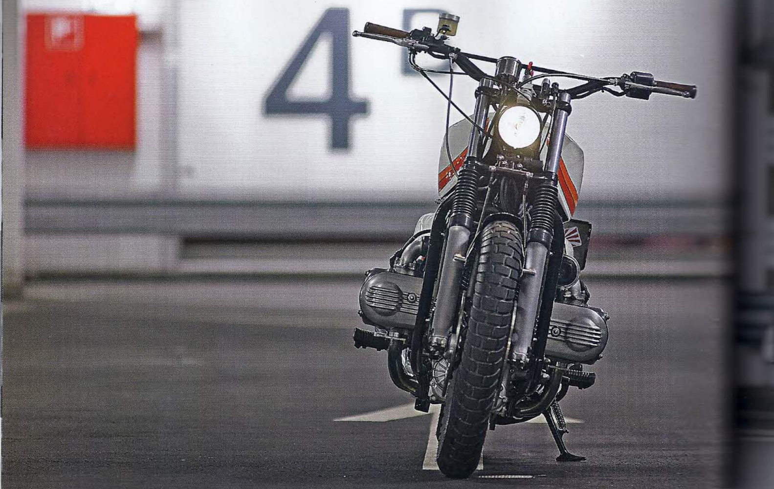
Vierzylinder. Von vorne dominieren die beiden Zahnriemenschächte die Silhouette der Gold Wing-Tracker
